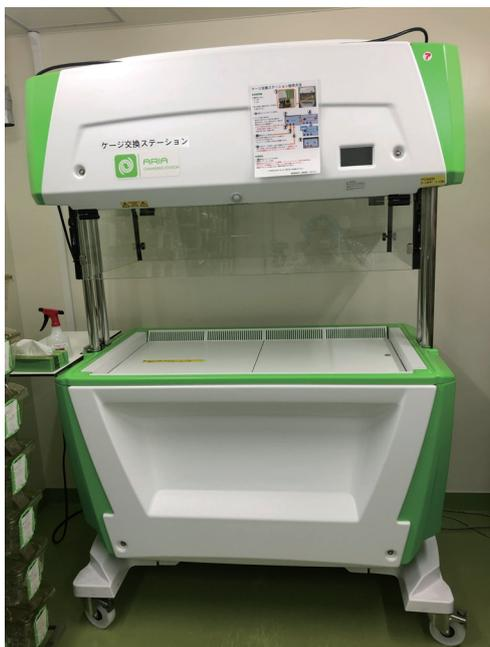
動物資源部門鹿田施設 感染実験区域 BSL-2 マウス飼育室は個別換気型飼育ケージシステムを導入し、ケージ毎に高い密封能力を有した室として整備していますが、ケージ交換は汎用の安全キャビネット内で行わずを得ず、物品の出し入れ、スペースの狭さなど、作業性の面で改善が望まれていました。
