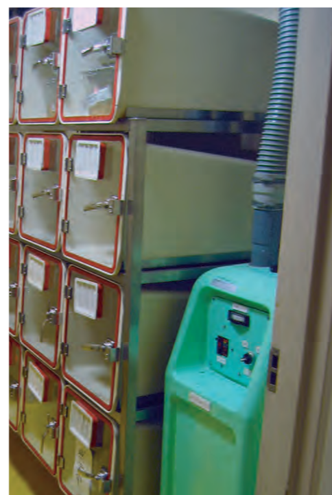
個別換気式(BBH)ラック。BOX前面から取り入れたエアはフィルタユニットの力でBOX奥から吸い込まれ、HEPAフィルターを通して排気される。
