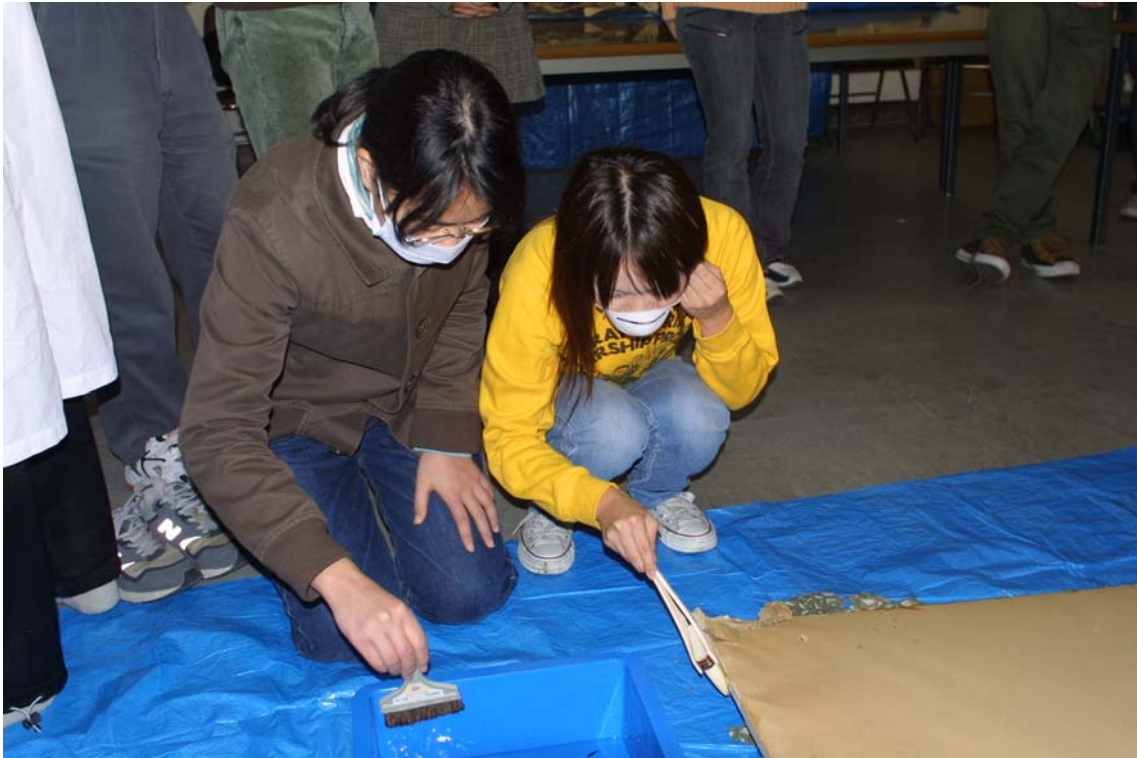
図 7 刷毛で接着部分を湿らせる
