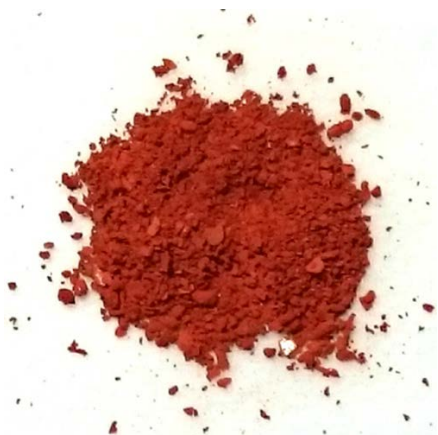
図2 アルミニウムを40%含んだ鞣状酸化鉄を加熱して作成した赤色顔料
