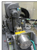
85kW 自動車駆動用 モータ試験装置
