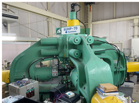
六軸加圧式川井型超高压発生装置 6UHP/6-axis high-pressure apparatus, 6UHP-7
