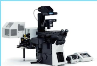
共焦点レーザー走査型顕微鏡FV1000/1200をベースにした超解像システムです。
